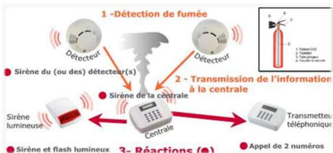
Figure 87 : système de détection de fumée.
