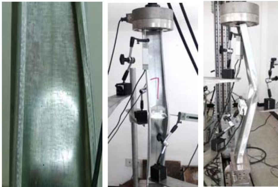
Figure 2 Les modes d'instabilité local, distorsionnel et global des colonnes à parois minces (Yao, 2017)
