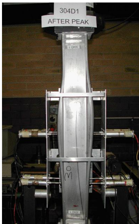
Figure 3.2 L'instabilité distorsionnelle d'une colonne en C
