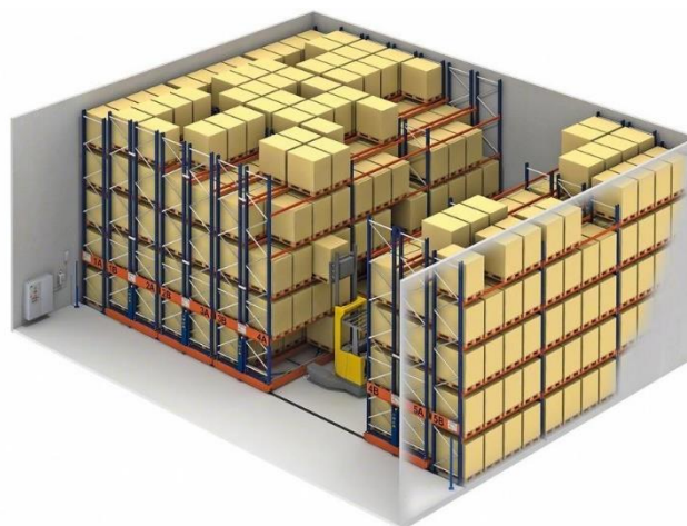
Figure 1.9 : Schéma en 3D d'un AS/RS à racks glissants
