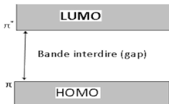
Figure 1.6 : structure de bandes des polymères conducteurs [3].
