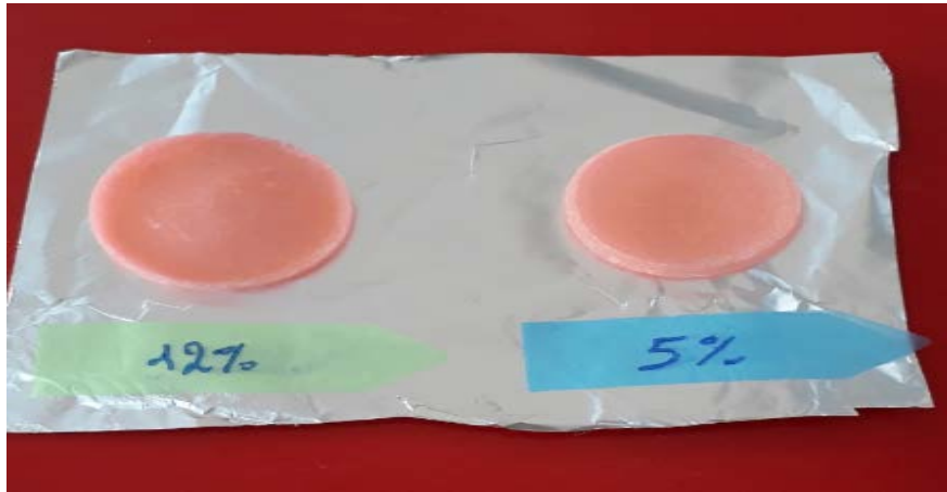
Figure 12: Gonflement du réseau (cellulose/polyHEMA) dans une solution colorée d'EOSINE Y
