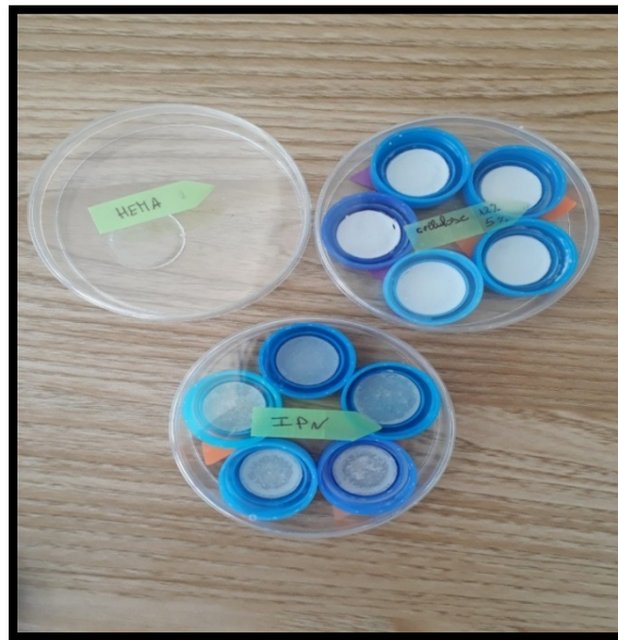
Figure07 : Pastilles finales du réseau IPN (cellulose/polyHEMA)
