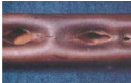
Figure A.19 : Tube endommagé par effet de marteau [93]
