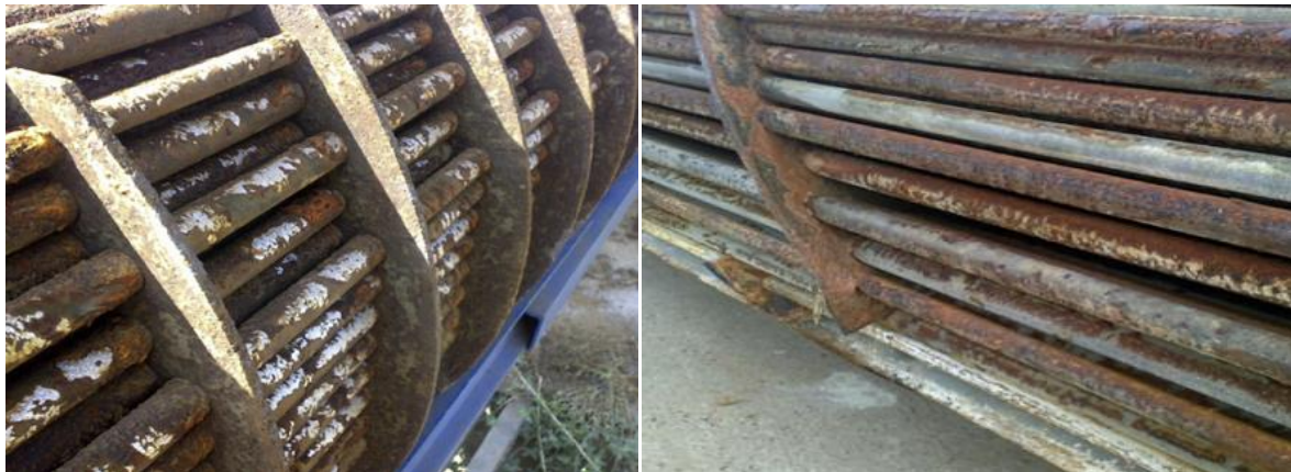
Figure I.15 : Les deux échangeurs de chaleur étudiés [17].
