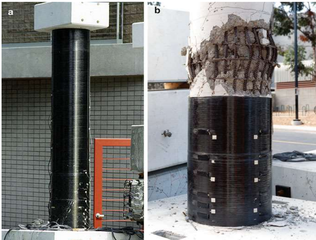
Figure 1.17. Colonne enveloppée d'une enveloppe en fibre de carbone / époxy [Courtoisie de B. Kad.]
