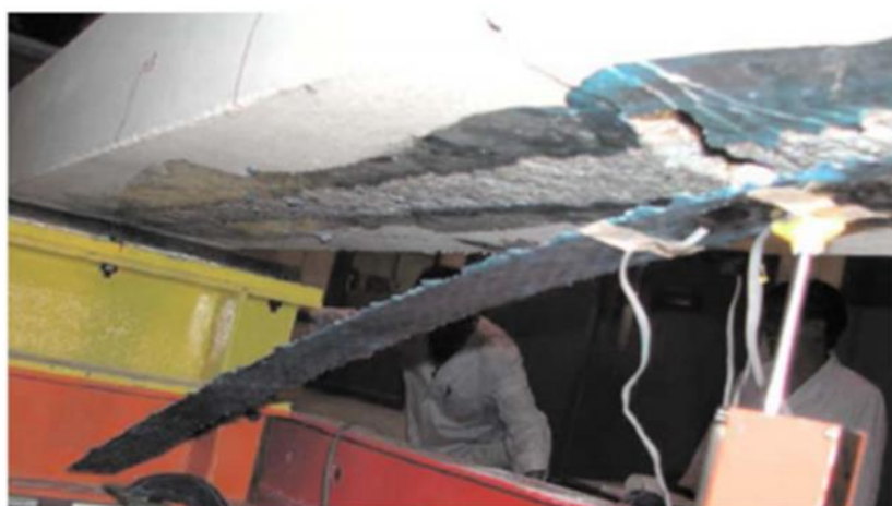
Figure 3.1. Phénomène du décollement de la plaque (Wu & Huang, 2008)
