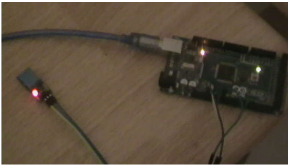
Figure 40 : le montage du capteur DHT11 avec la carte Arduino
