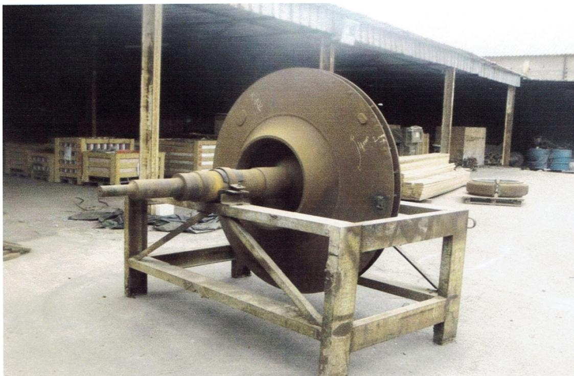
**Photo 6.8** Roue du ventilateur central K102
