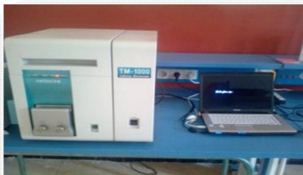
Figure II.4 : Appareil de Microscopie électronique à balayage
