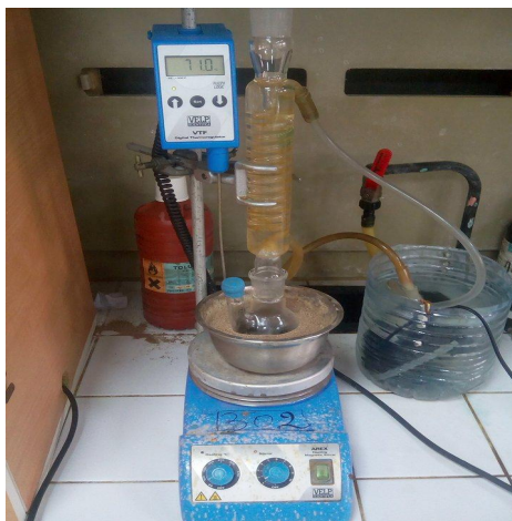
Figure II.5 : Le montage utilisé pour le test catalytique.
