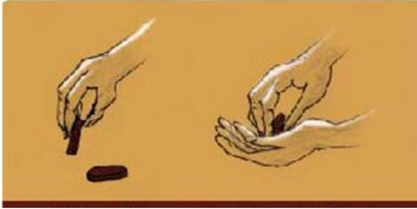
الشكل رقم 40: اختبار المقاومة في الحالة الجافة، نقلا عن OPVM
