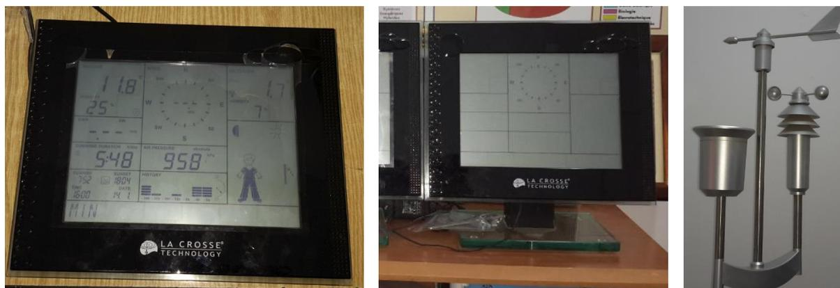
Figure 2.3. Photos prises pour les stations météorologiques : anémomètre et Consoles
