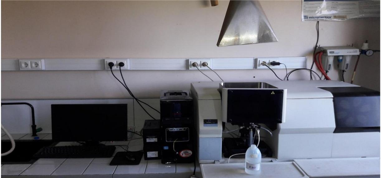
**Figure II.5:** le spectromètre d'absorption atomique.
