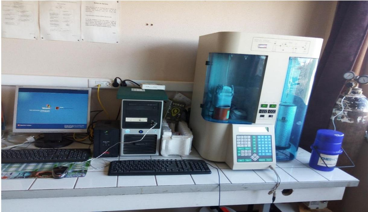
**Figure II.2:** Adsorption-désorption de  $\text{N}_2$ -Appareil utilisé NOVA 1000°.
