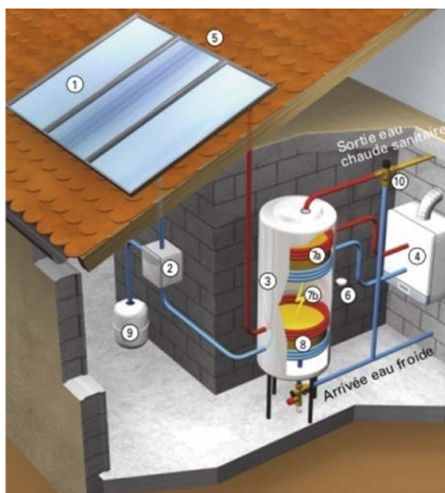
Figure 2.11. Exemple d'un système chauffe-eau solaire individuel.
