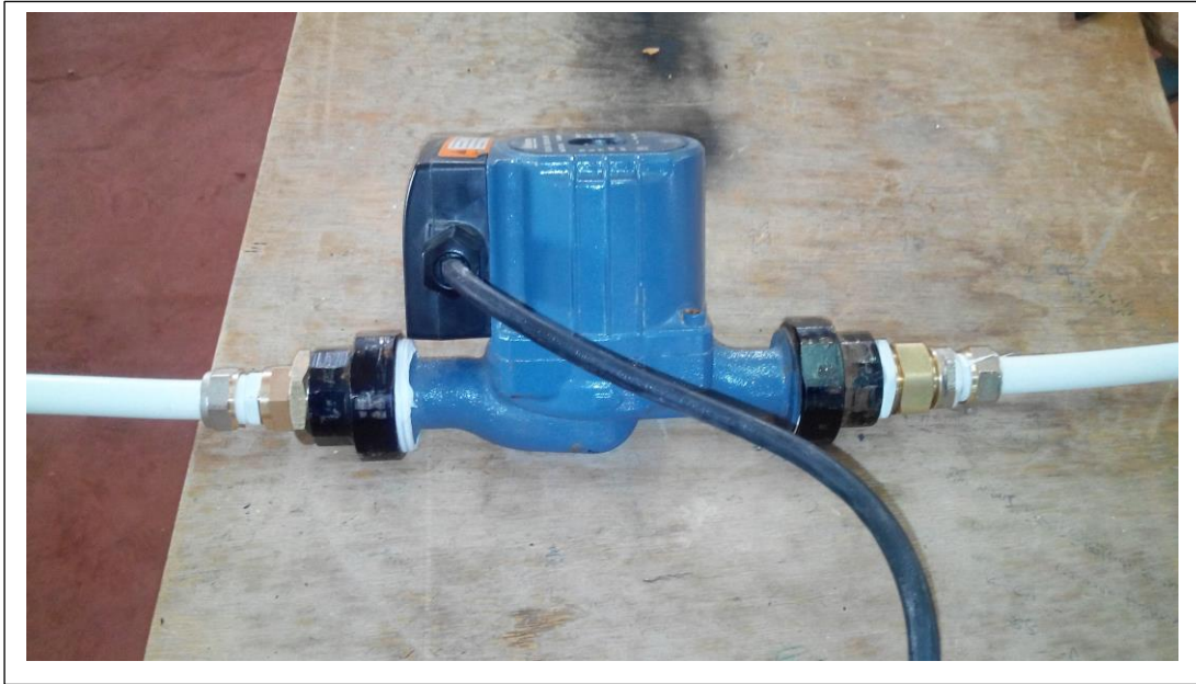
Fig III.11.B : pompe centrifuge utilisée
