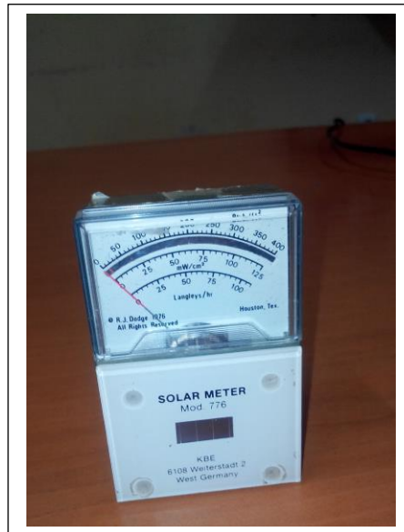
Fig III.12 : photographie du solarimètre
