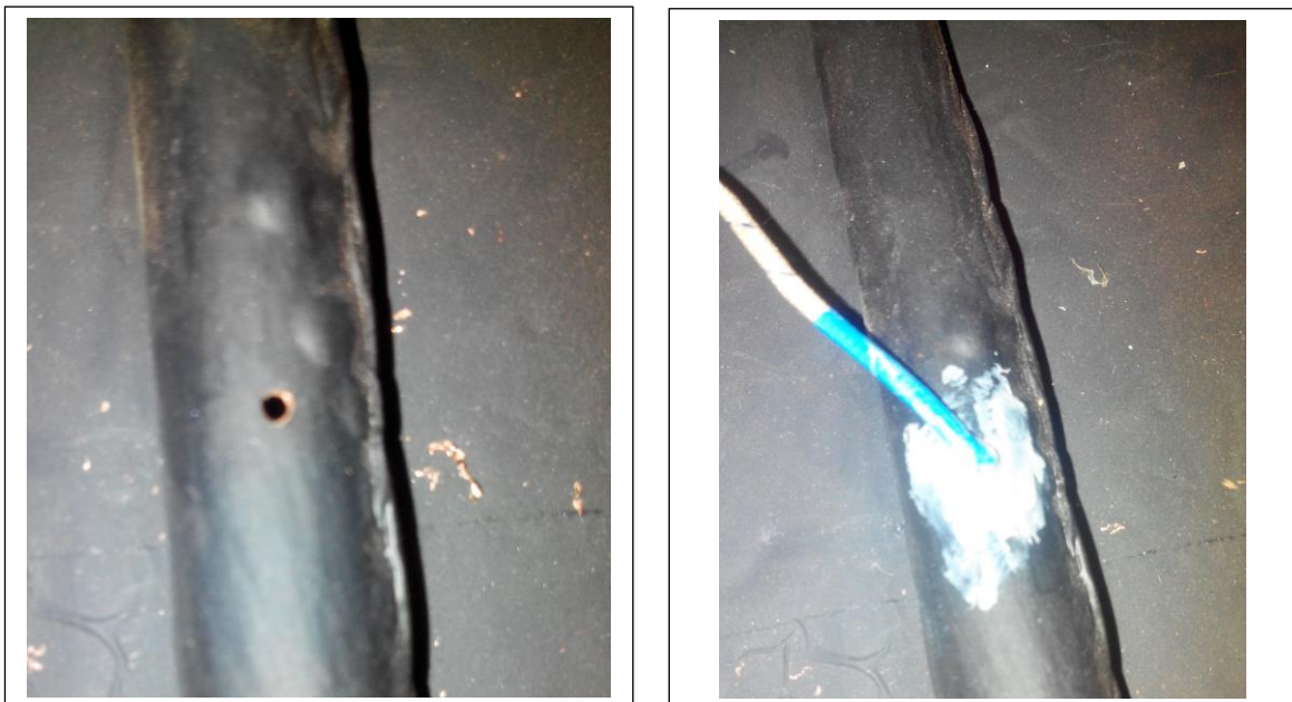
FigIII.15 : Photographies du tube lors de La colle des thermocouples
