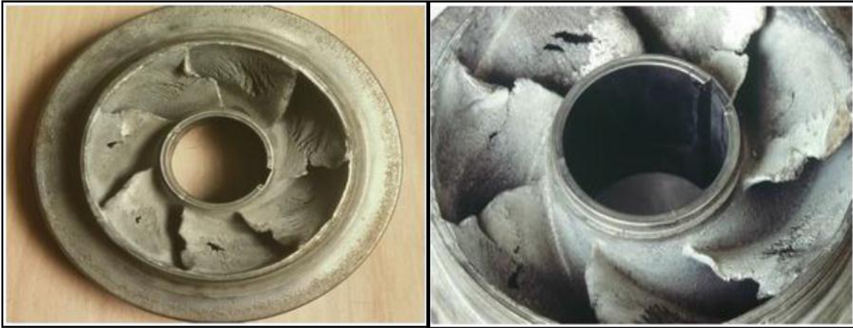
Figure 2-17 : Problème de cavitation
