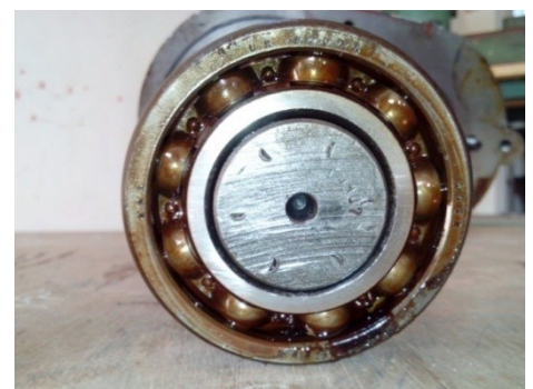
Photo IV.3 : L'usure des roulements
