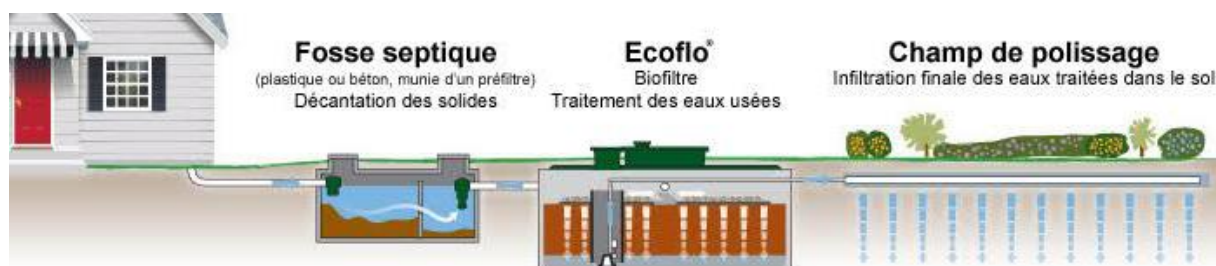
Figure 62 : Système Ecoflo Biofiltre 'traitement des eaux usées.
