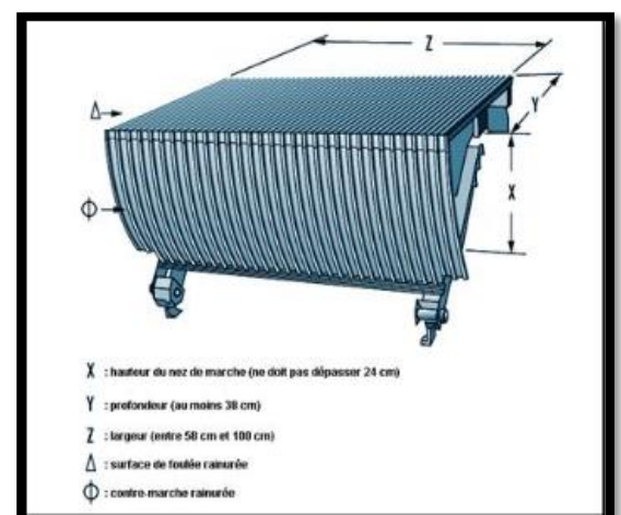
Figure 282 : détails de l'escalator
