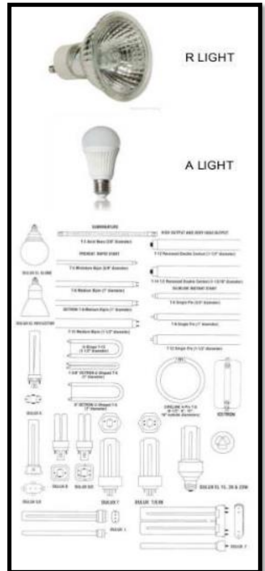
Figure 104 : type de lampe utilisé pour l'éclairage
