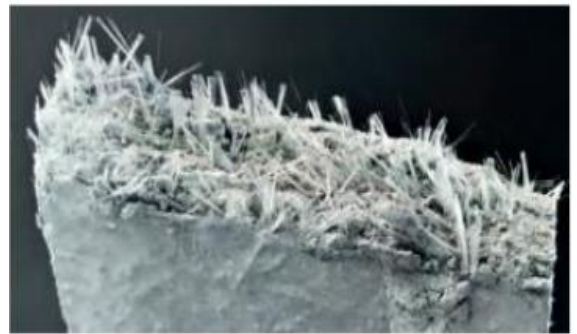
Figure 273 : Renforcement de fibre dans le composite ciment-verre
