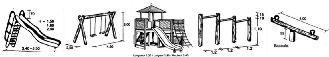
Figure 195. Toboggan, balançoires, maison à grimper et glisser, barres en gradins et bascule (source : Neufert 8 e édition, « les éléments des projets de construction », pp 340).
