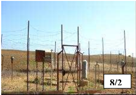
EQUIPEMENT D'UNE STATION EXPERIMENTALE PARCELLES D'EROSION DE 100 m 2 AVEC SYSTEME DE RECEPTION
