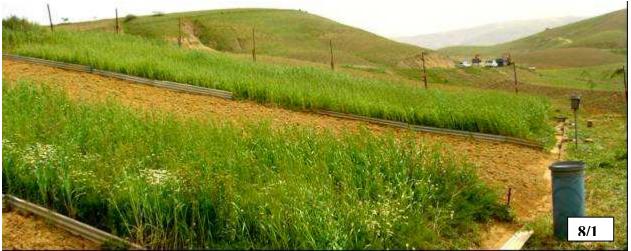
BATTERIE CLOTUREE CONSTITUEE DE CINQ PARCELLES D'EROSION DE 100 m 2
