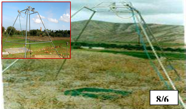
EXPERIMENTATION SOUS PLUIES SIMULEES : SIMULATEUR DE PLUIE ET PARCELLE DE 1M2
