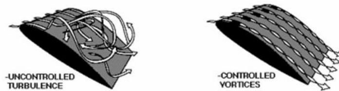
FIG. 1.11 – Contr  le de la vorticit   gr  ce    des riblets ou des syst  mes LEBU
