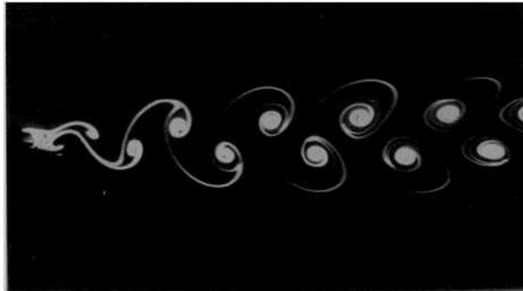
FIG. 1.8 – Sillage d'un cylindre à Re=105
