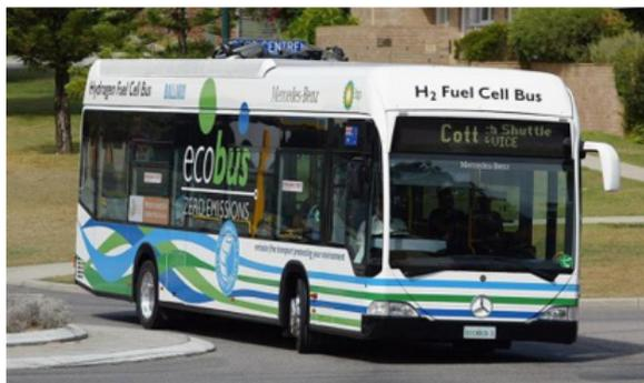
FIGURE 1.10 – Auto bus à pile à combustible
