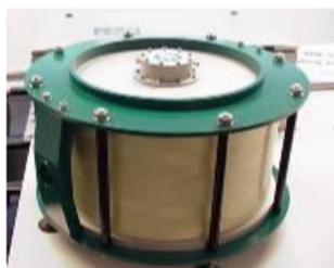
(a) Volant d'inertie du tramway
