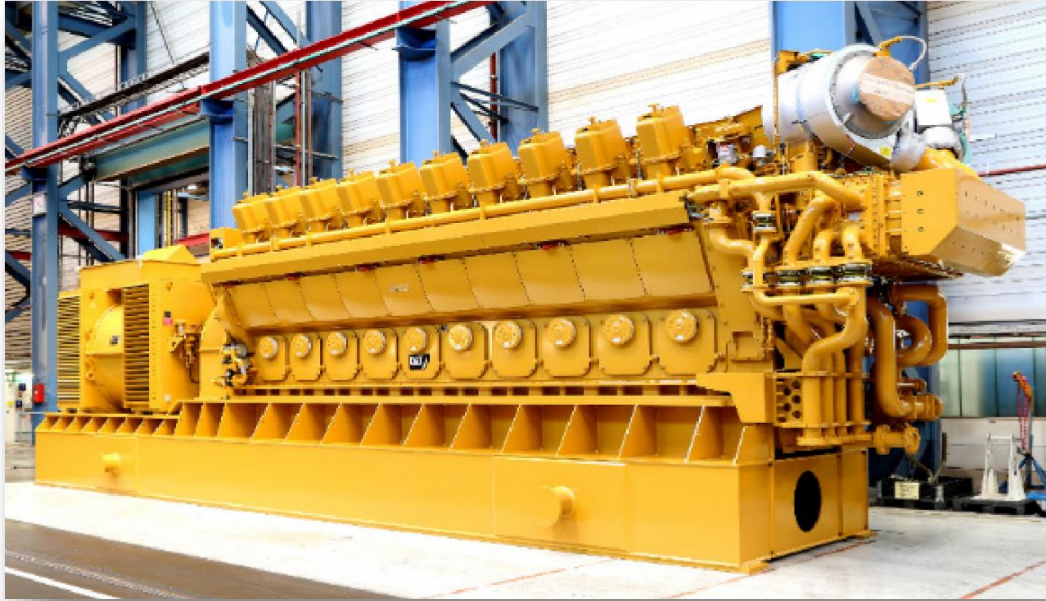
Figure. II.1. Installation de cogénération à moteur alternatif dans une installation industrielle de marque Caterpillar
