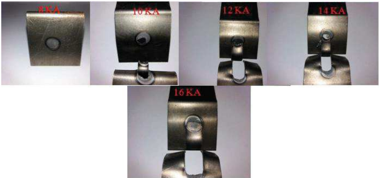
Figure III.11 Les éprouvettes (e=1mm) rompues après l’essai de traction pour T=18 Cycle et F=6 Bars
