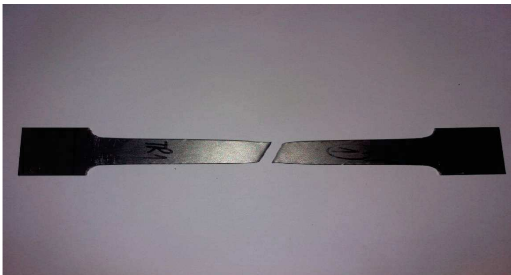
Figure II.16 : Eprouvette normalisée après rupture.
