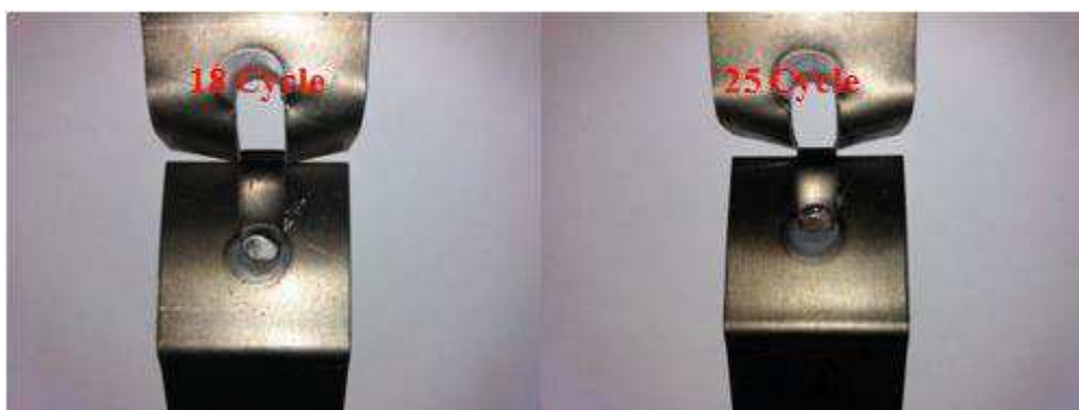
Figure III.35 : Faciès de rupture pour les éprouvettes soudées avec 14 KA e=1 mm
