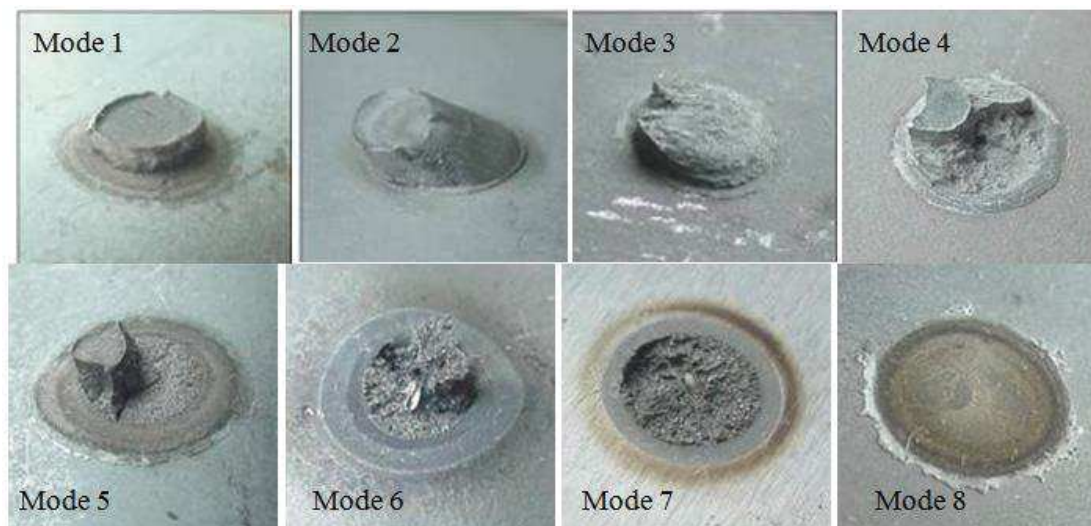
Figure III.1 : Différents modes de ruptures recensés par l'AWS [9]
