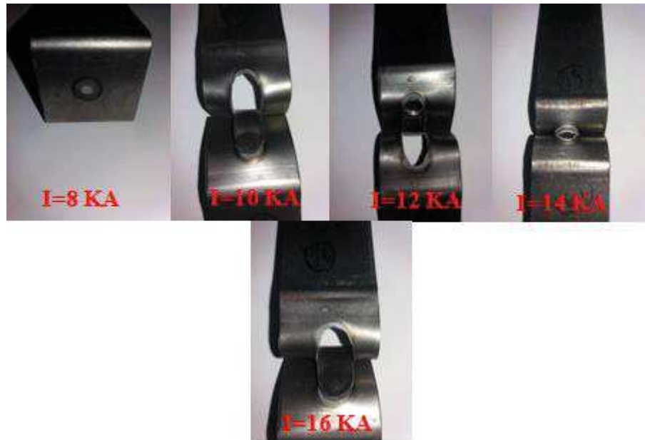
Figure III.8 Les éprouvettes ( e=2\text{mm} ) rompues après l'essai de traction pour T=25 Cycle et F=7\text{Bars}
