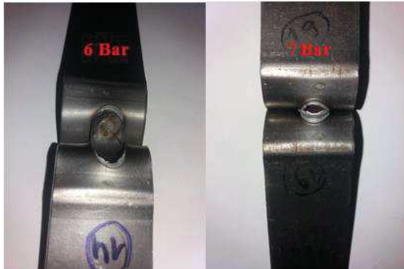
Figure III.22 Faciès de rupture pour les éprouvettes soudées avec 14 KA et 25 Cycle
