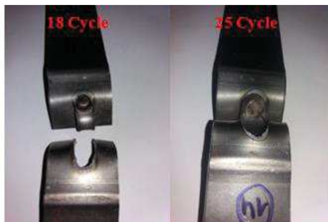
Figure III.29 : Faciès de rupture pour les éprouvettes soudés avec 14 KA
