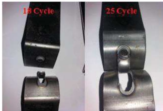
Figure III.28 : Faciès de rupture pour les éprouvettes soudés avec 10 KA
