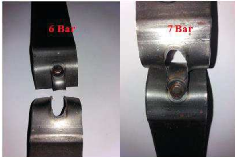
Figure III.20 : Faciès de rupture pour les éprouvettes soudés avec 14 KA et 18 Cycle
