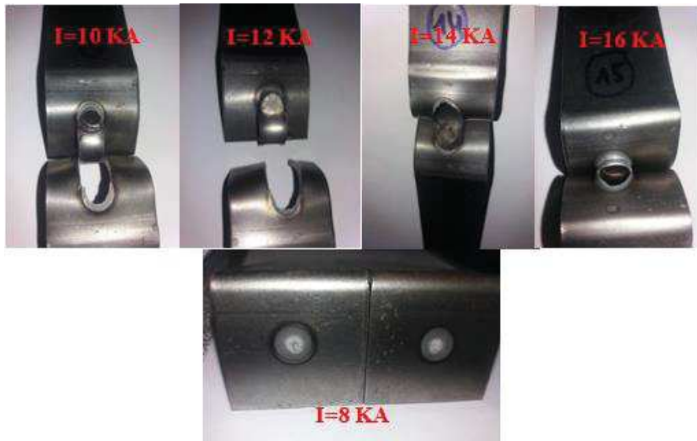
Figure III.6 Les éprouvettes (e=2mm) rompues après l'essai de traction pour T=25 Cycle et F=6 Bars
