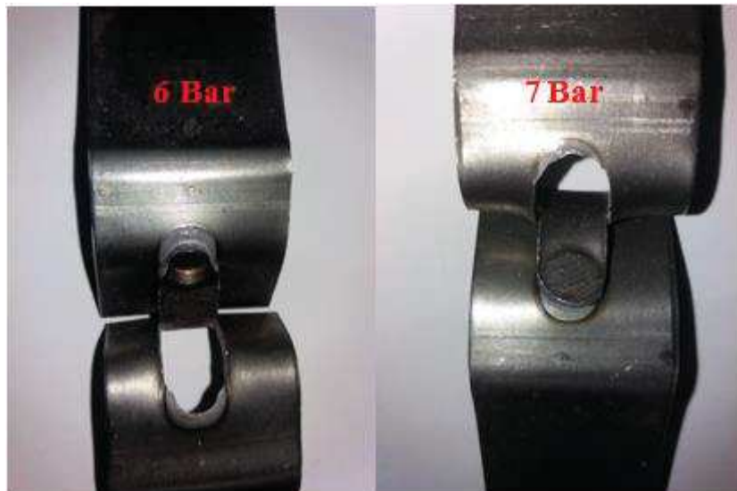
Figure III.18 : Faciès de rupture pour les éprouvettes soudées avec 12 KA
