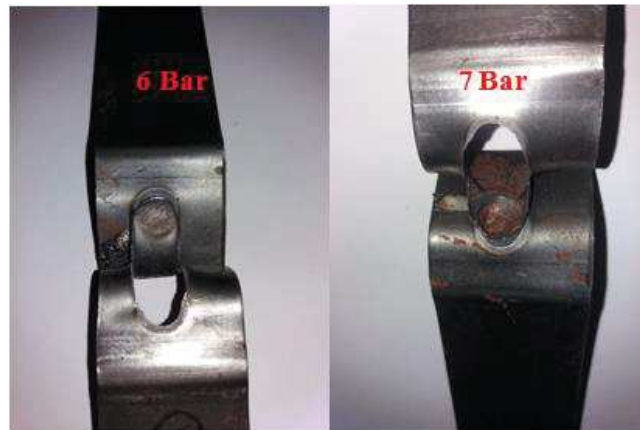
Figure III.24 Faciès de rupture pour les éprouvettes soudées avec 16 KA et 18 Cycle
