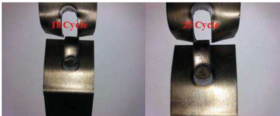
Figure III.33 : Faciès de rupture pour les éprouvettes soudés avec 12 KA e=1 mm
