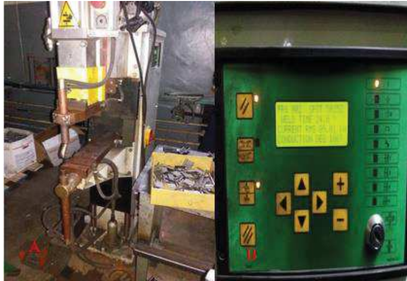
Figure II.10: (A) Machine de soudage (B) tableau de commande
