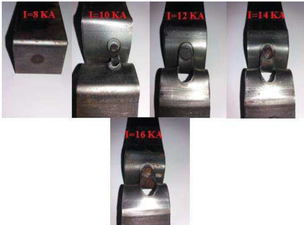
Figure III.4 Les éprouvettes (e=2mm) rompues après l’essai de traction pour T=18 Cycle et F=7 Bars
