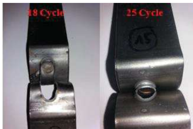
Figure III.31 : Faciès de rupture pour les éprouvettes soudées avec 16 KA
