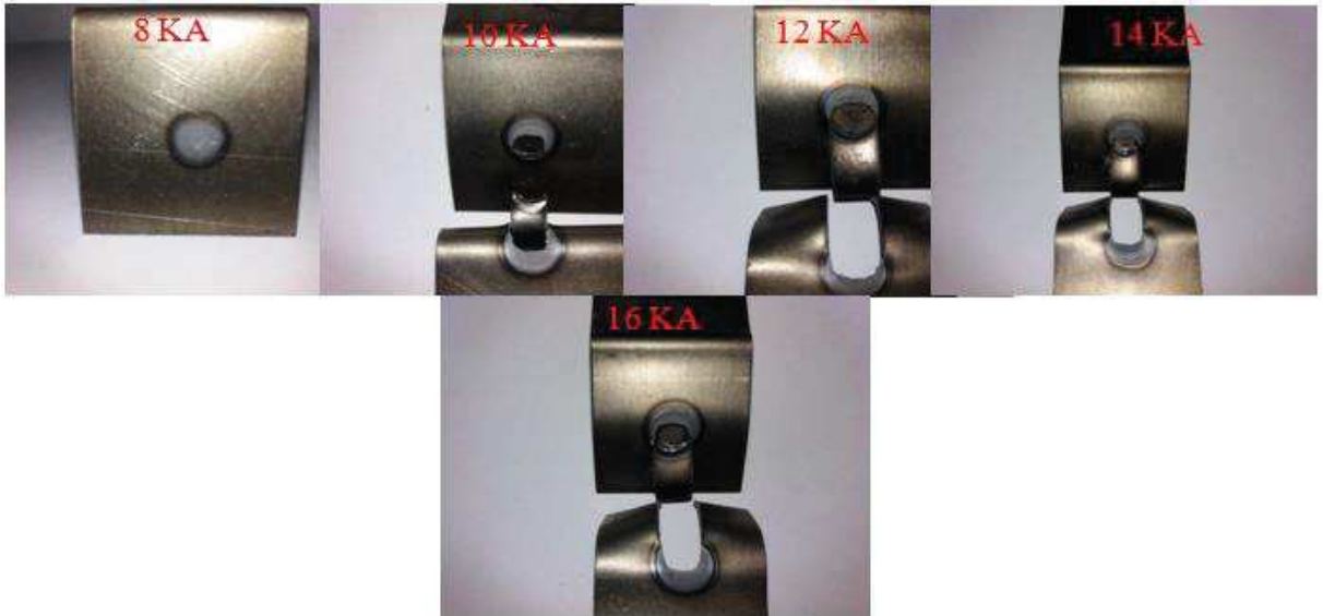
Figure III.15 Les éprouvettes (e=1mm) rompues après l’essai de traction pour T=25 Cycle et F=6 Bars
