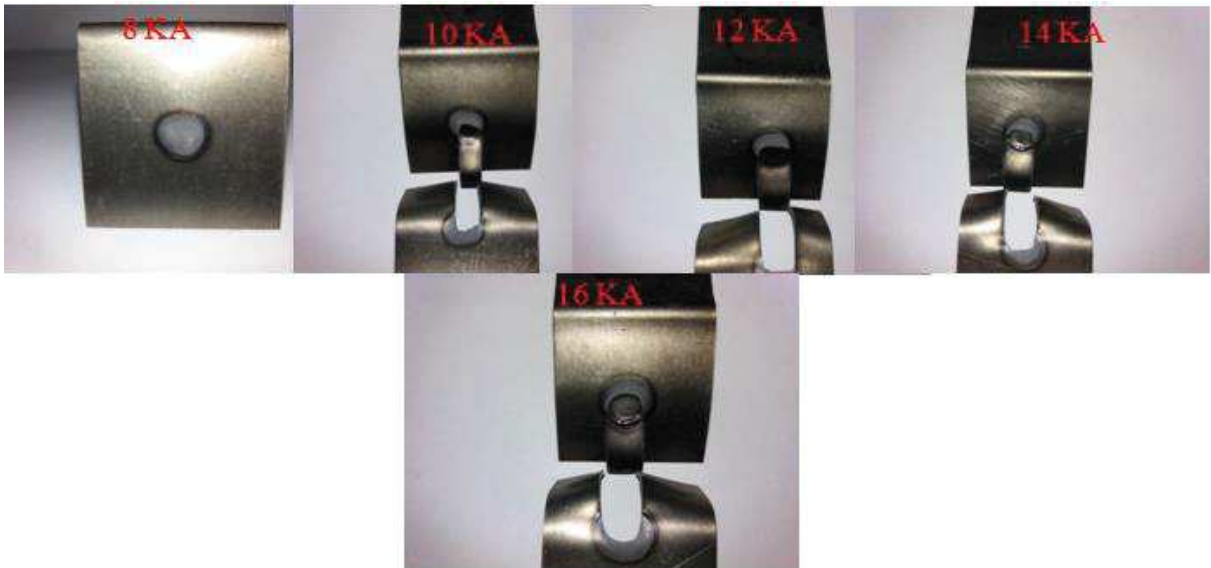
Figure III.13 Les éprouvettes (e=1mm) rompues après l’essai de traction pour T=18 Cycle et F=7 Bars
