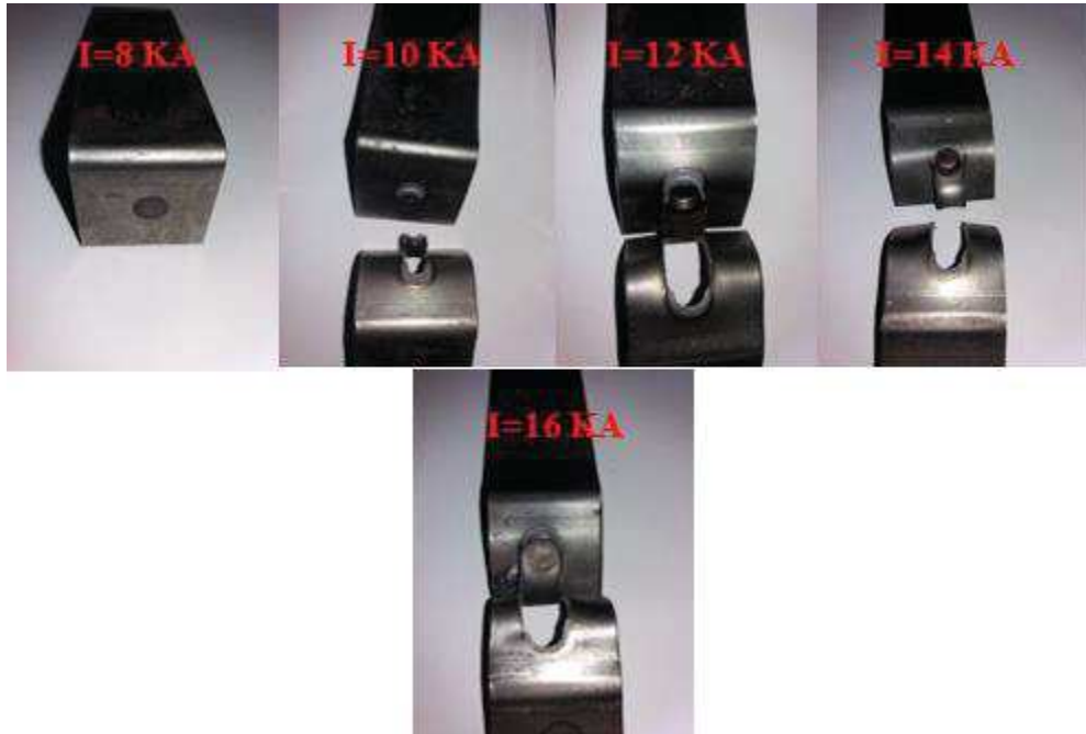
Figure III.2 Les éprouvettes ( e=2 mm) rompues après l'essai de traction pour T=18 Cycle et F=6 Bars
