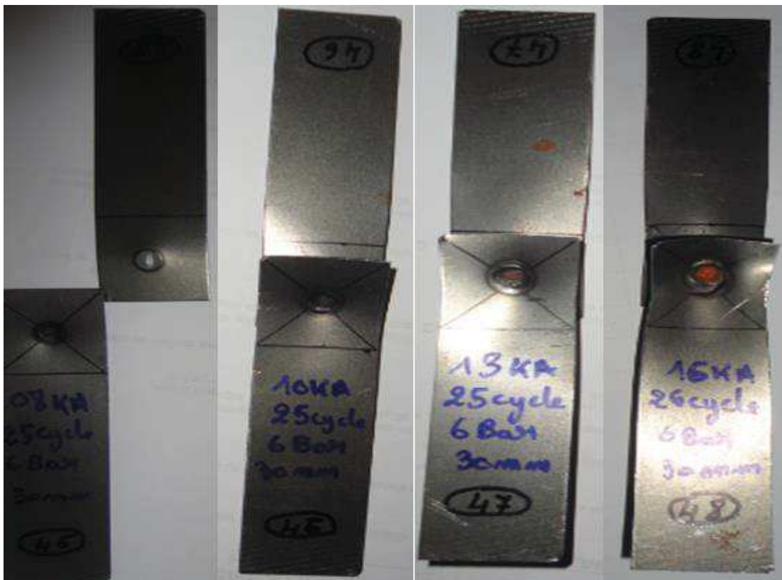
Figure III.19 : Eprouvettes rompues après l'essai de traction pour T=18 Cycle, A=30\text{mm} F=6 Bars et e=1\text{mm}
