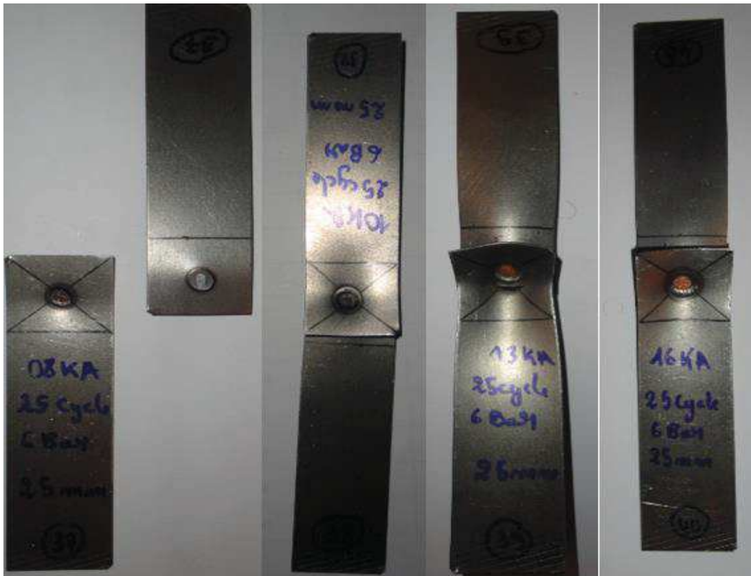
Figure III.23 : Les éprouvettes rompues après l'essai de traction pour T=25 Cycle, A=20 mm F=6 Bars et e=1 mm
