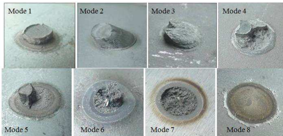
Figure III.1. Différents modes de ruptures recensés par l'AWS, d'après[17]
