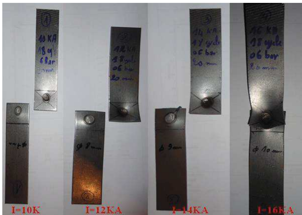
Figure III.3 Eprouvettes rompues après l'essai de traction pour T=18 Cycle, A=20mm et F=6 Bars, et e=2\text{mm}
