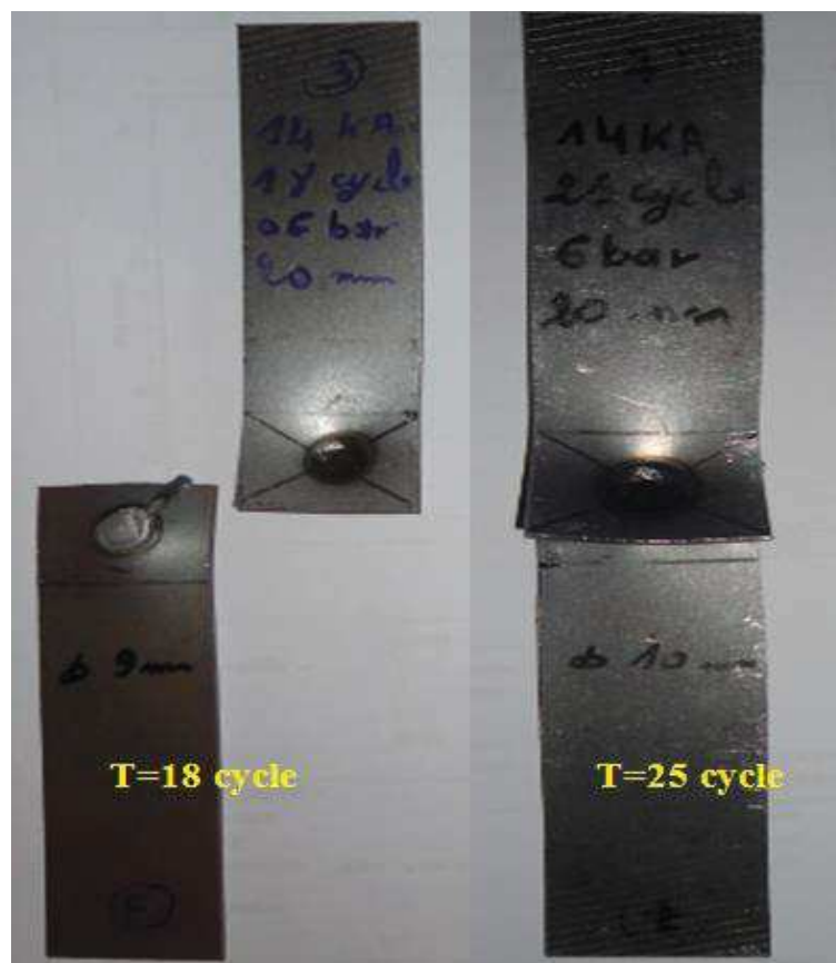
Figure III.27 : Eprouvettes rompues après l'essai de traction pour I=14\text{KA} , F=6 Bars et A=20\text{mm}
