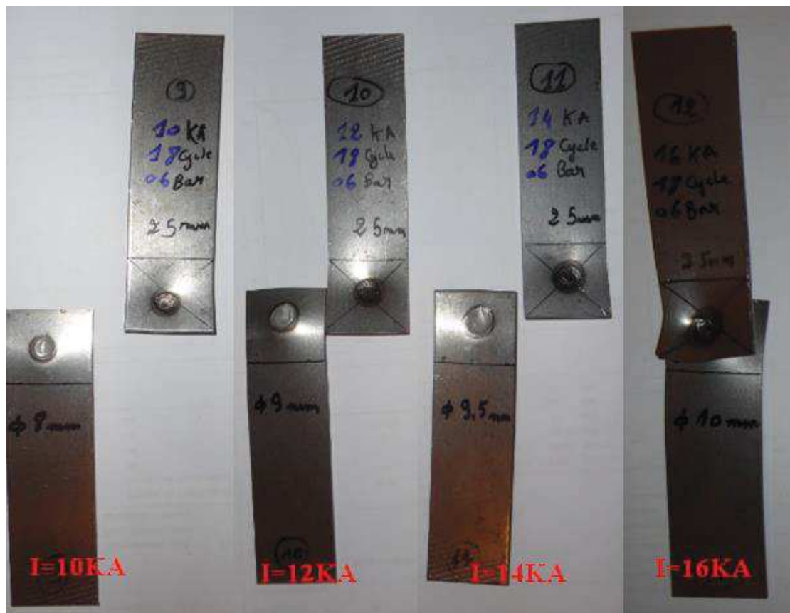
Figure III.5 : Eprouvettes rompues après l'essai de traction pour T=18 Cycle, A=25\text{mm} F=6 Bars, et e=2\text{mm}
