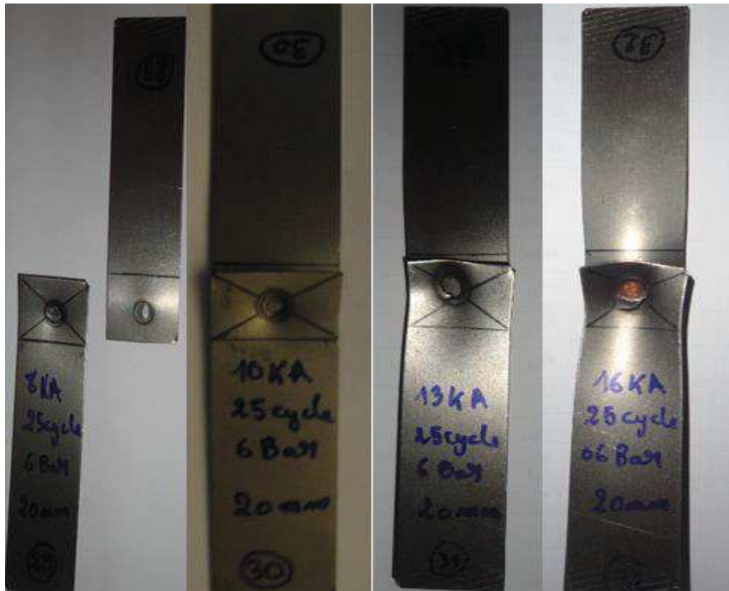
Figure III.21 : Les éprouvettes rompues après l'essai de traction pour T=25 Cycle, A=20mm F=6 Bars et e=1mm
