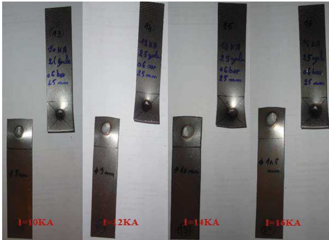
Figure III.11 : Eprouvettes rompues après l’essai de traction pour T=25 Cycle, A=25mm F=6 Bars, et e=2mm.
