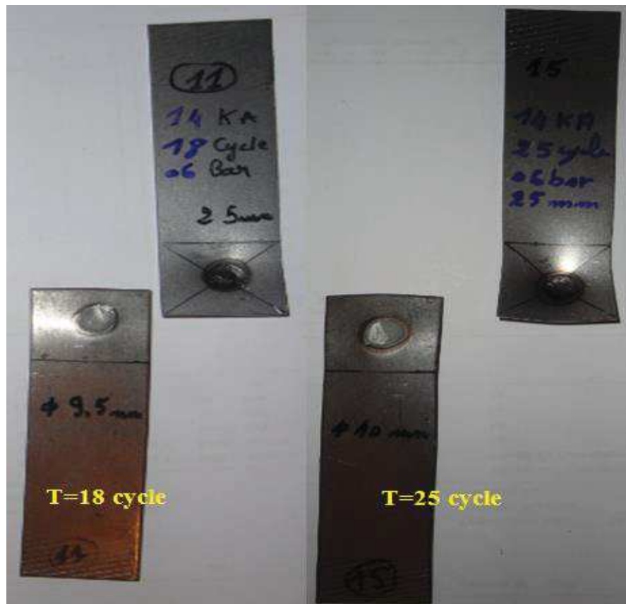
Figure III.29 : Eprouvettes rompues après l'essai de traction pour I=14KA, F=6 Bars et A=25mm
