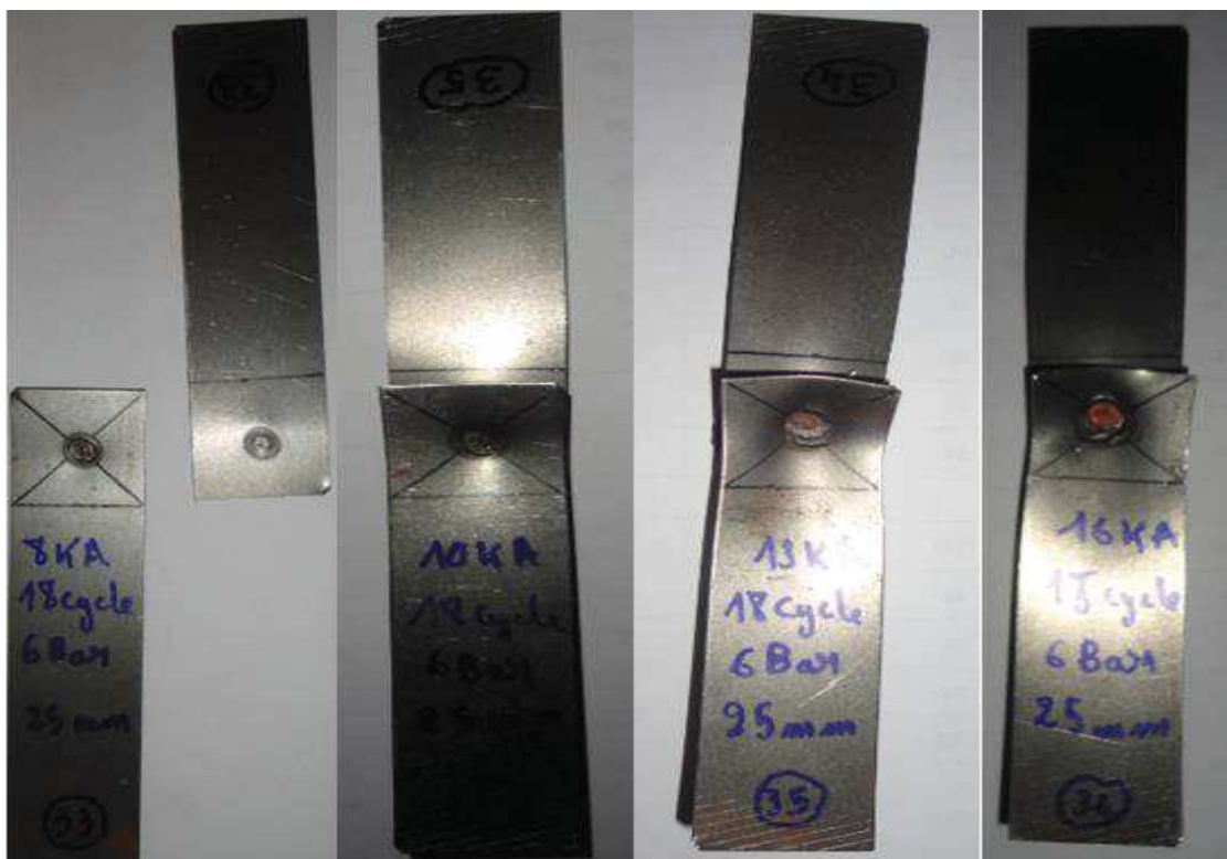
Figure III.17 : Eprouvettes rompues après l'essai de traction pour T=18 Cycle, A=25\text{mm} F=6 Bars et e=1\text{mm} .
