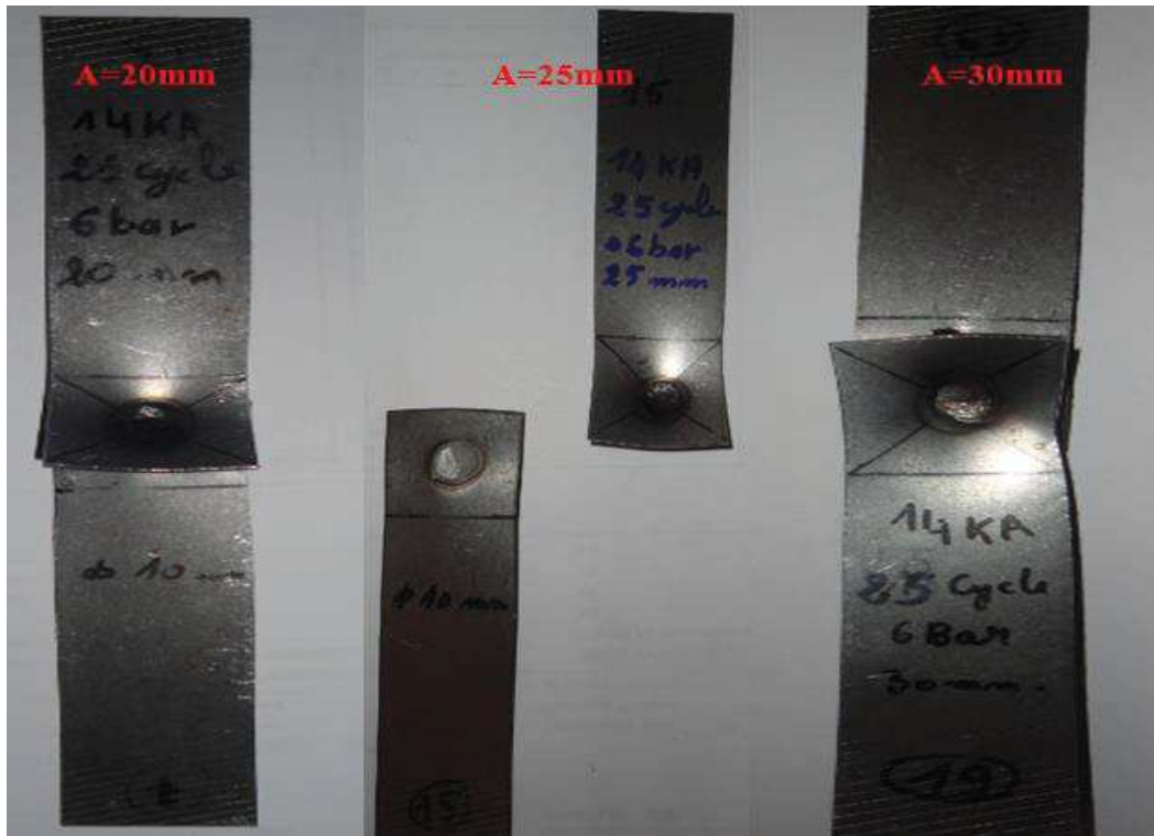
Figure III.35 Eprouvettes rompues après l'essai de traction pour T=25 Cycle et F=6 Bars Avec différent recouvrement
