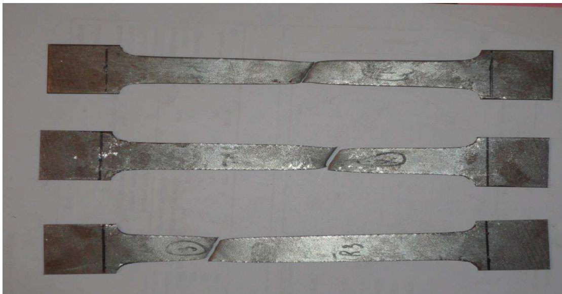
Figure II.14 : Eprouvettes rompus après essai de traction.
