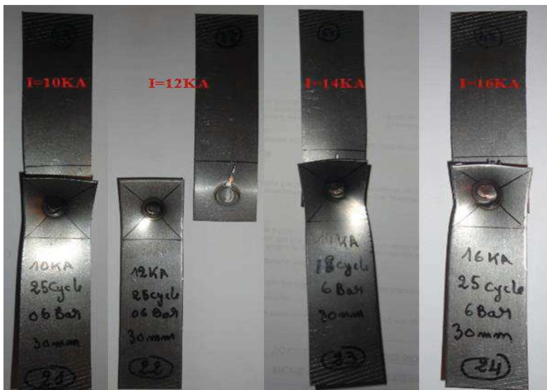
Figure III.13 : Epreuves rompues après l'essai de traction pour T=25 Cycle, A=30 mm F=6 Bars, et e=2 mm.
