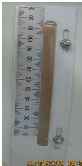
Fig. 4.7. Contrôle de niveau
