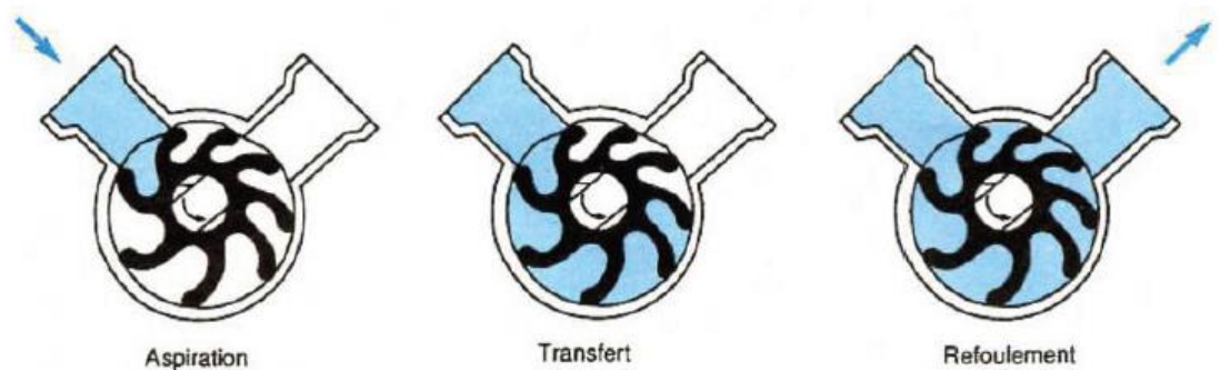
Fig. 1.7. Pompe à palettes flexibles
