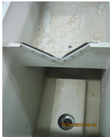
Fig. 4.2. Déversoir triangulaire à mince paroi
