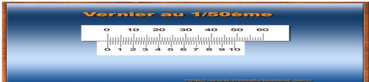
Figure A.5 : Vernier au 1/50 ème
