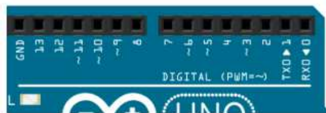
Figure IV-4 : les entrées/sortie de l'arduino [35]
