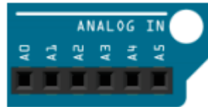
Figure IV-5 : les entrées analogiques [35]
