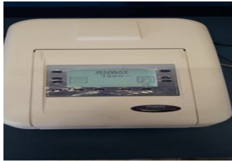
Figure 11 : Spectrophotomètre UV-Visible utilisé pour mesurer l'absorbance.
