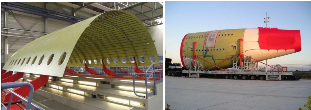
Figure 1.10 : Différentes sections de fuselage d'avions Airbus A380 (FUTURA-SCIENCES).
