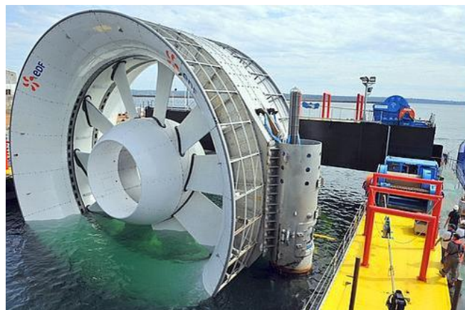
Figure 1.7 : Turbines sous-marines alimentées par la marée (THECONSTRUCTIONINDEX).
