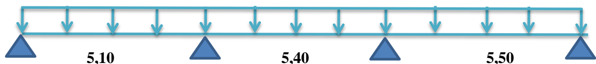
Fig.III-3 : Chargement d'une poutre continue.
