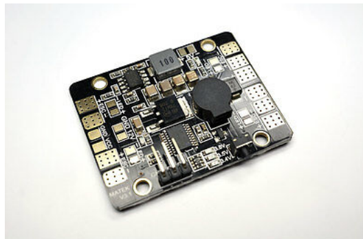
FIGURE IV.49 – Distributeur de tension
