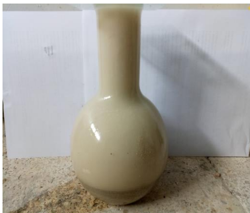
Figure III.3 : Essai de la masse volumique absolue du sable par la méthode du ballon.
