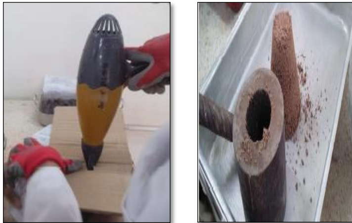
Figure III.15 : La détermination du coefficient d'absorption du sable
