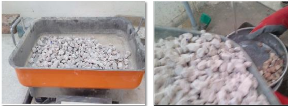
Figure III.10 : Essai propreté des graviers
