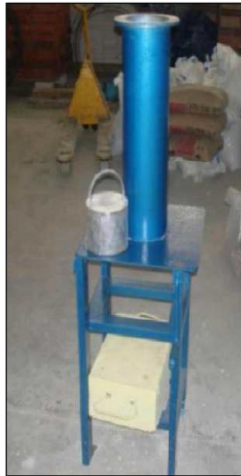
Figure III.16 : L'essai de compacité des granulats
