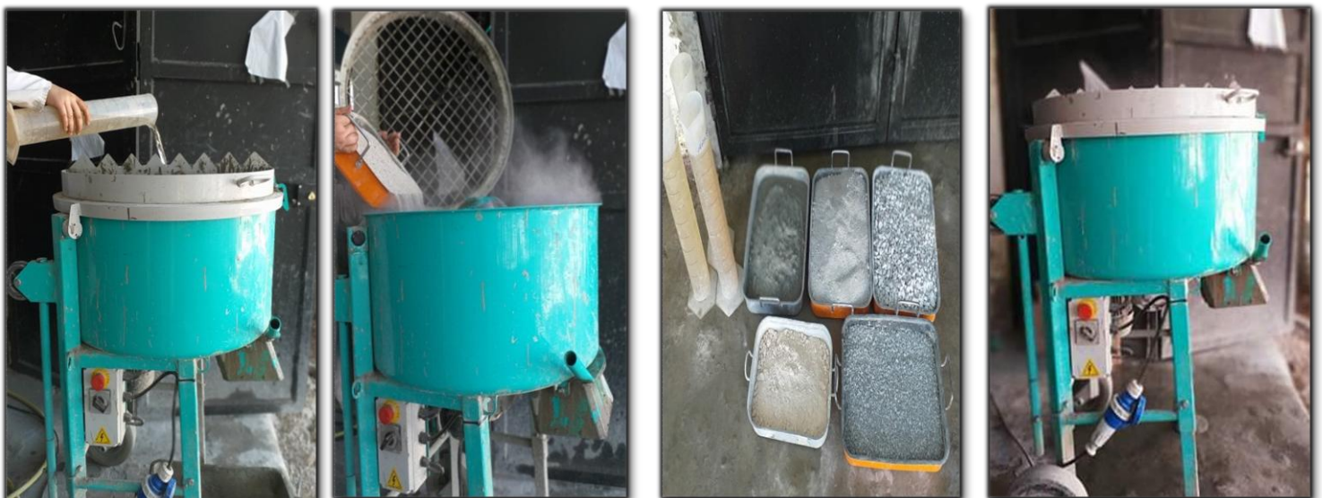
Figure IV.1 : Méthodologie de malaxage des bétons semi auto-plaçant
