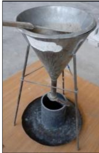
Figure III.2 : Caractérisation de la masse volumique apparente du ciment.
