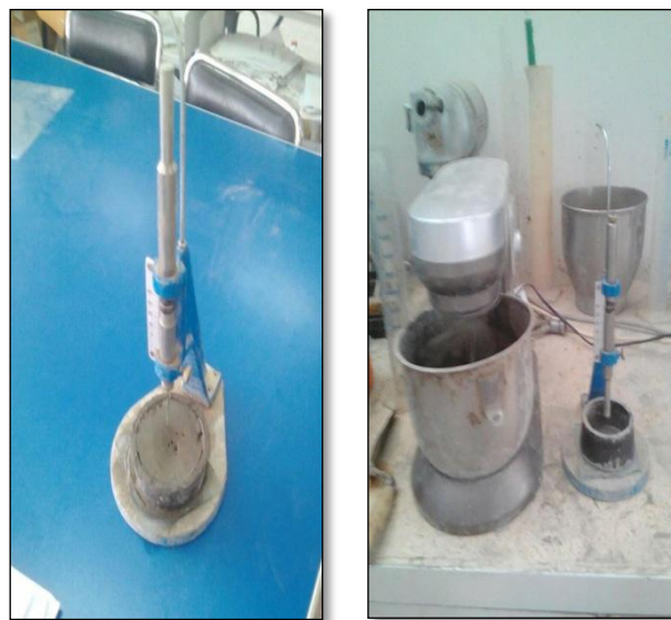
Figure III.4 : Essai de prise (l’appareil Vicat)
