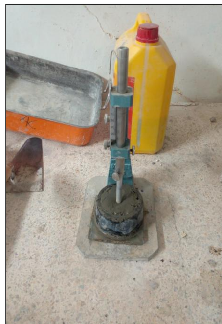
Figure III.3 : Essai de consistance (l'appareil Vicat)
