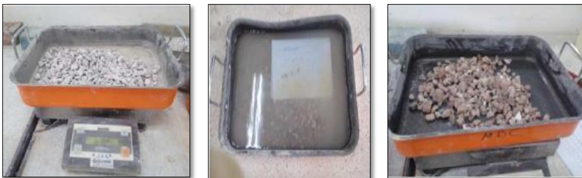
Figure III.14 : La méthode utilisée pour déterminer le coefficient d'absorption de Gravier
