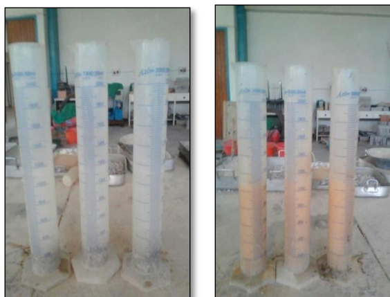
Figure III.11 : Détermination de la masse volumique absolue (Méthode du l'éprouvette graduée)
