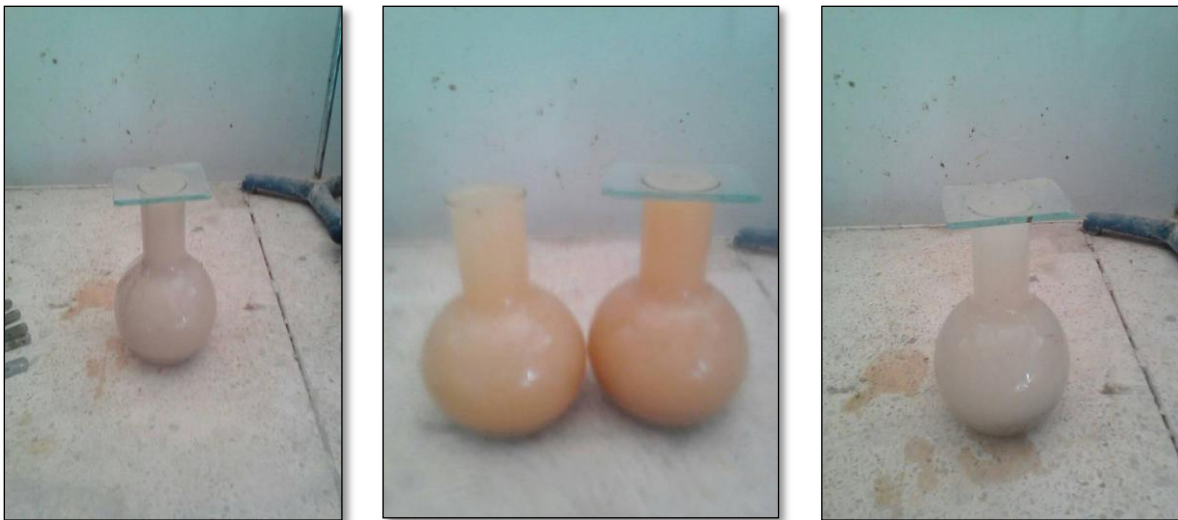
Figure III.12 : Détermination de la masse volumique absolue (Méthode du ballon)
