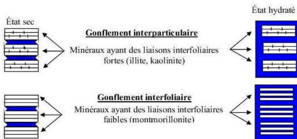
Figure 0-6 : Mécanismes de gonflement des argiles par hydratation (BENMESSAOUD, 2017).
