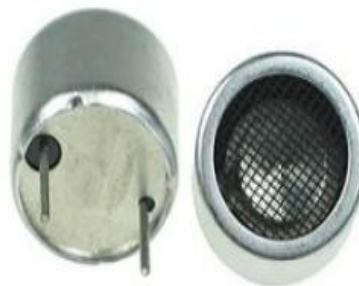
Figure I-9 : Capteur à ultrason standard pour une fréquence supérieure à 40 KHz
