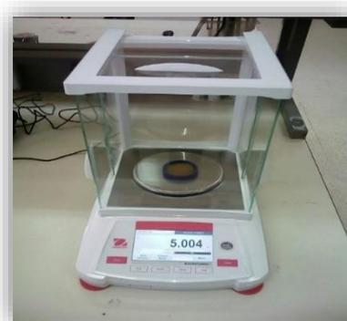
**Figure 17 : balance électronique.**
