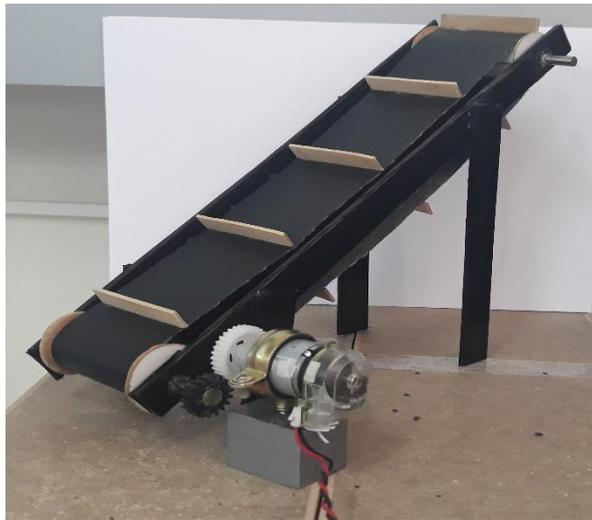
Figure 56 : L'assemblage du convoyeur.
