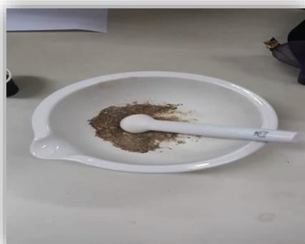
Figure 15 : Mortier de broyage.
