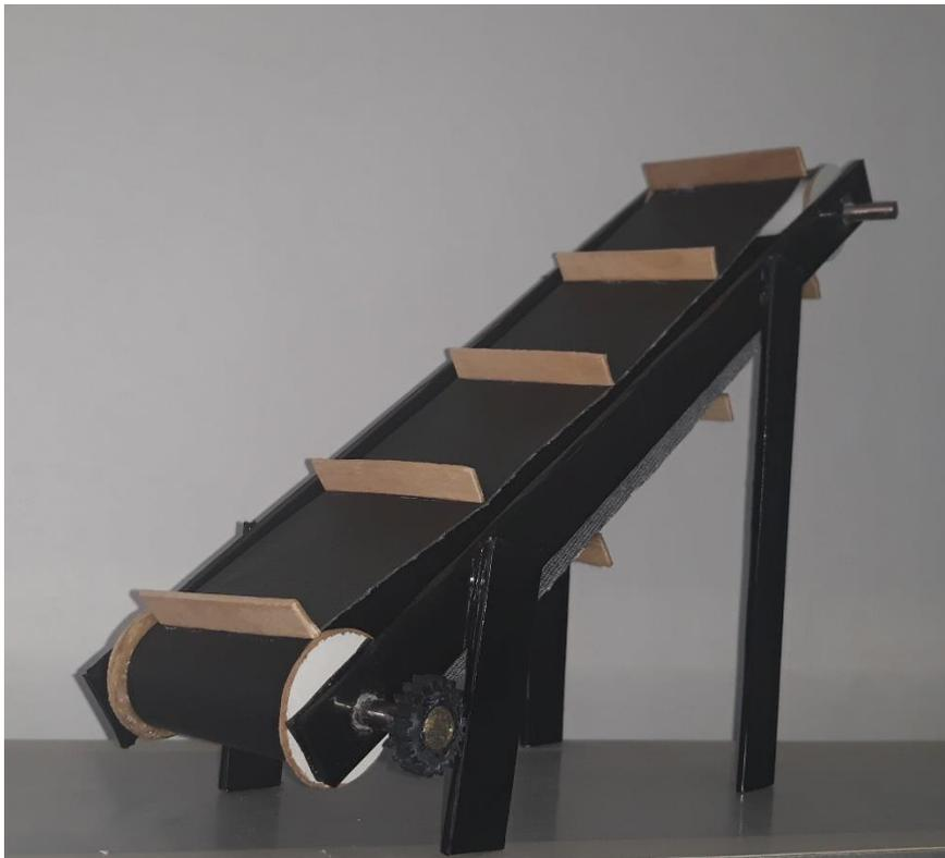
**Figure 53 : Assemblage des composants mécanique du convoyeur.**
