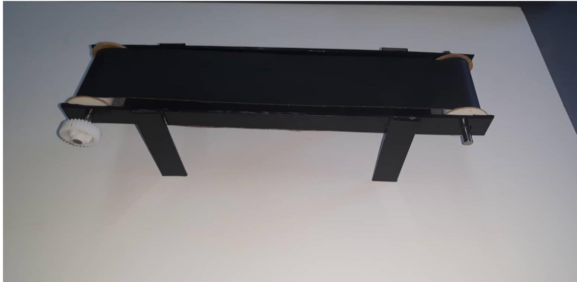
Figure 60 : Assemblage des composants mécanique du convoyeur.
