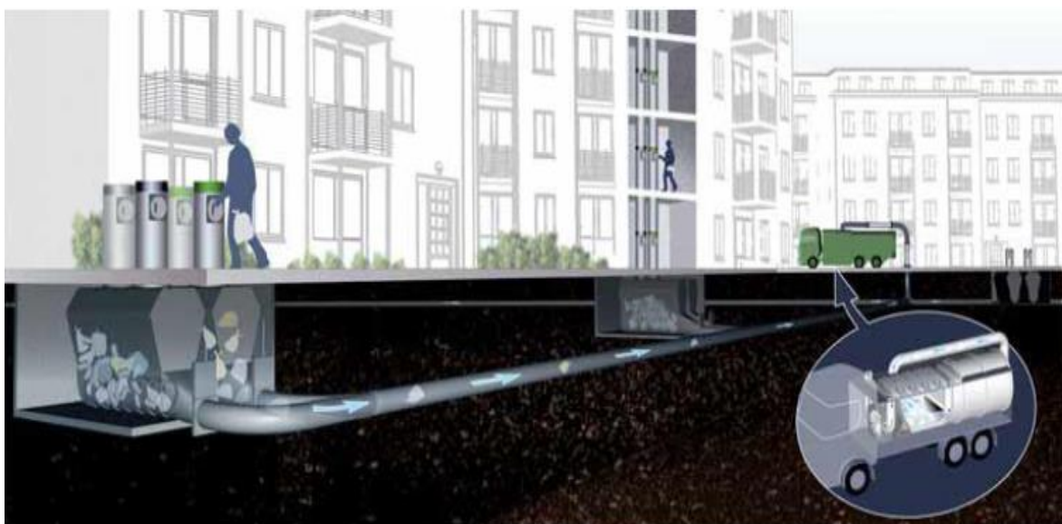
Figure 8 : Schéma de principe de la collecte pneumatique des ordures ménagères. [52]
