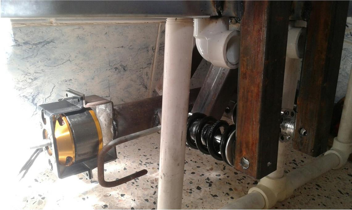
FIGURE 5.8 – Fixage les deux moteurs avec l'essieu arrière
