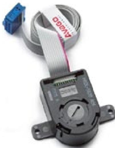
FIGURE 4.16 – Conducteurs de ligne d'encodeur
