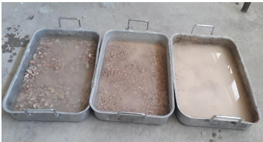
Figure 3.8 : Absorption des granulats minéraux utilisés.
