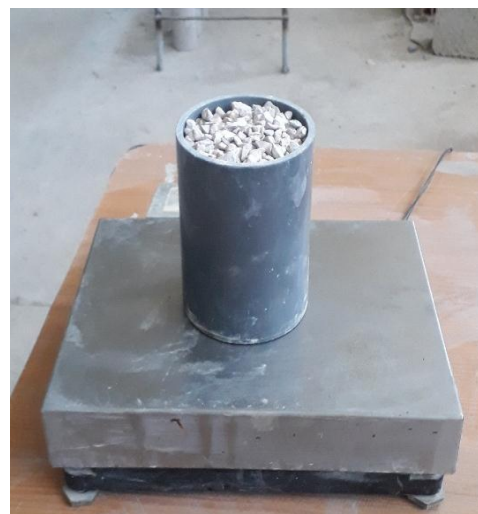
Figure 3.7. Essais utilisés pour la mesure des masses volumiques apparente et absolue des granulats minéraux utilisés.
