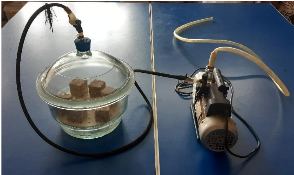
Figure 3.24. Essais de porosité accessible à l'eau.
