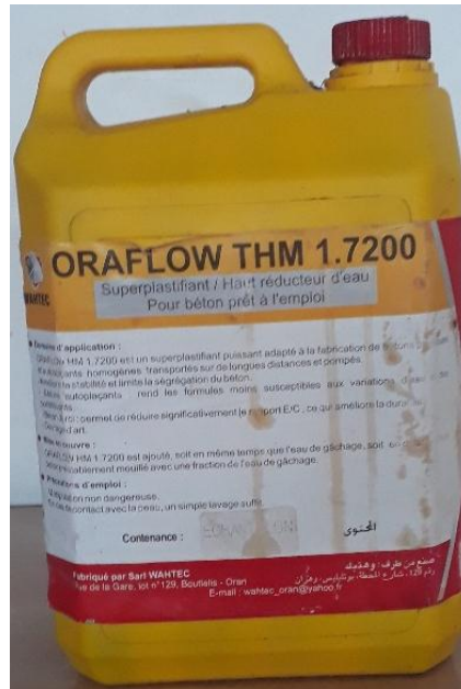
Figure 3.3. Super-plastifiant utilisé pour les bétons.
