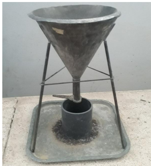
Figure 3.1 : Caractérisation de la masse volumique apparente du ciment.
