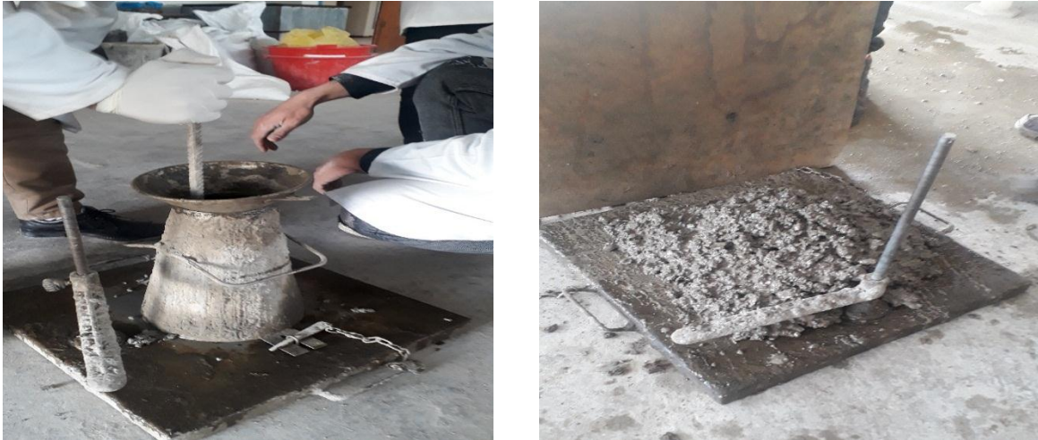
Figure 3.16 : Essai d'affaissement au cône d'Abrams.
