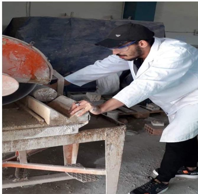
Figure 3.15 : Rectification des surfaces des éprouvettes à l'aide de la scie à béton.
