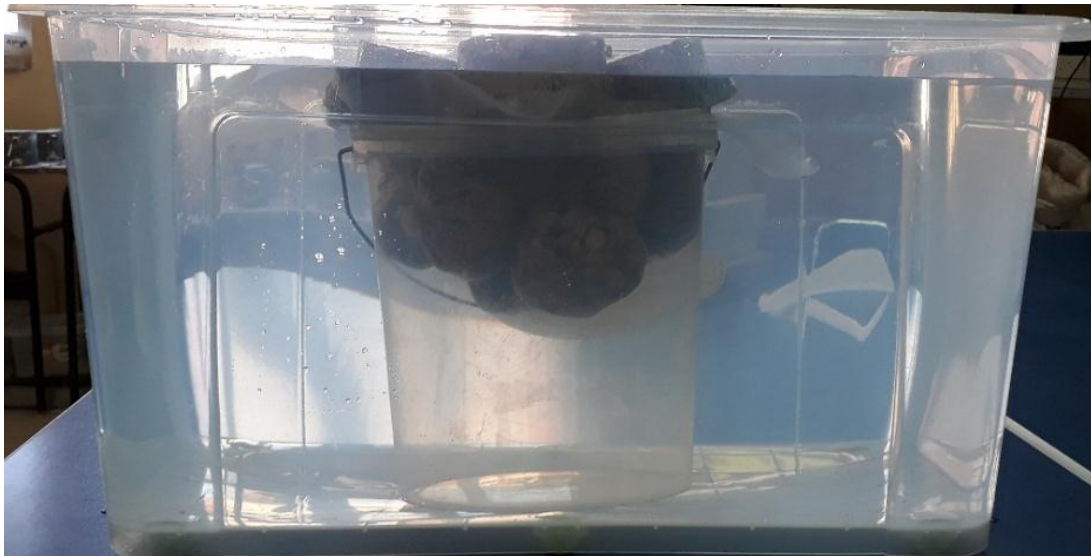
Figure 3.12. Immersion des échantillons de liège.
