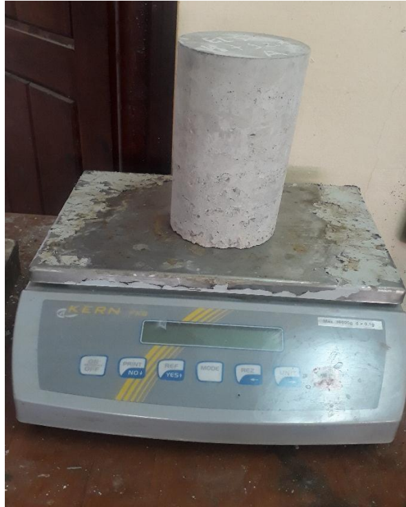
Figure 3.19 : Essais de masse volumique des bétons.
