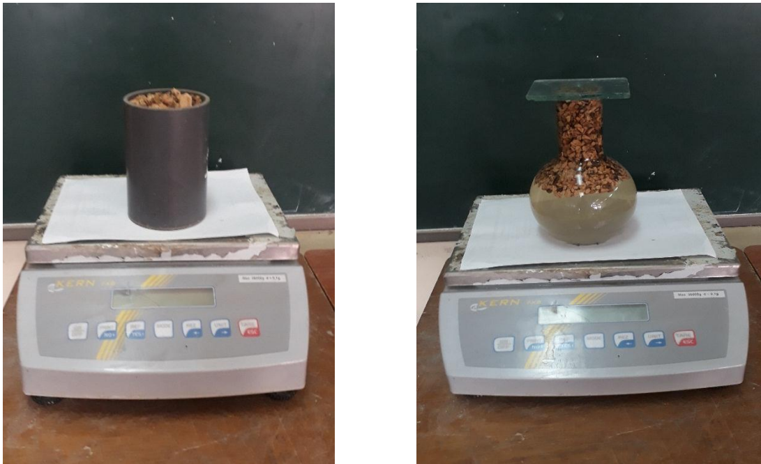
Figure 3.11. Essais utilisés pour la mesure des masses volumiques apparente et absolue des granulats de liège utilisés.
