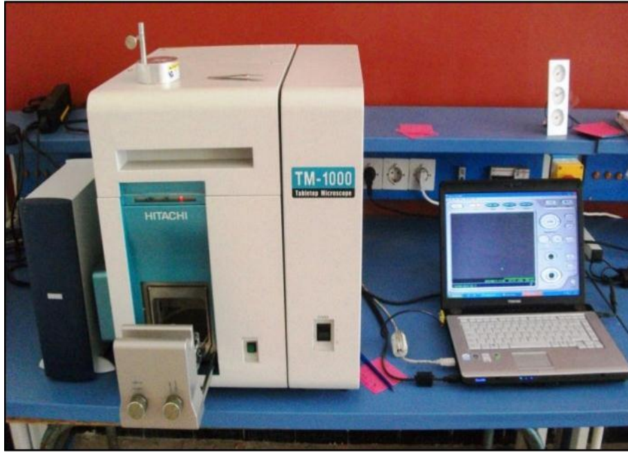
Figure 3.25 : Microscope électronique à balayage type HIRACHI-TM1000.
