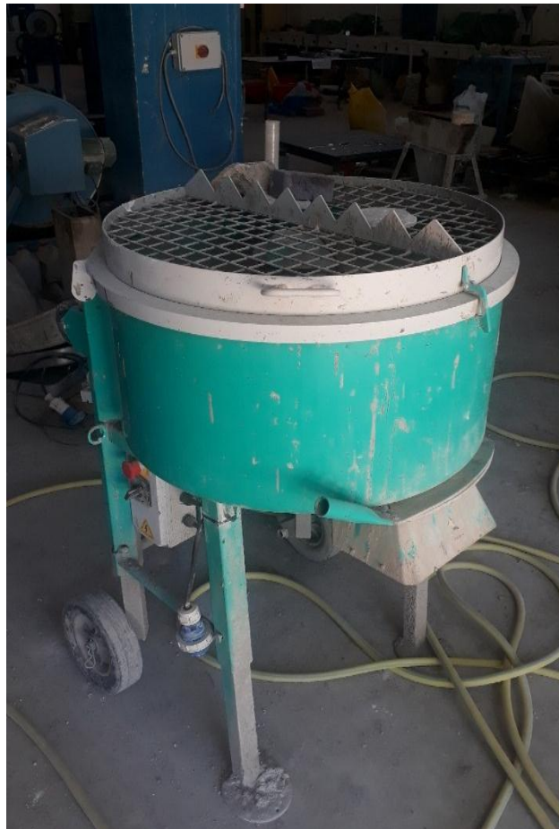
Figure 3.13 : Malaxeur utilisé pour la formulation de nos bétons.
