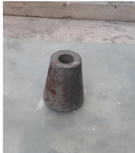
Figure 3.4. Essai d'étalement au mini-cône.
