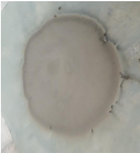
Figure 3.4. Essai d'étalement au mini-cône.
