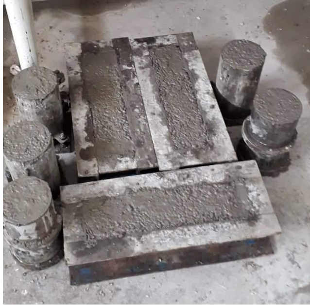
Figure 3.14 : Table vibrante utilisée pour le serrage des échantillons de béton.
