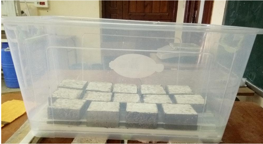
Figure 3.22. Essai d'absorption capillaire
