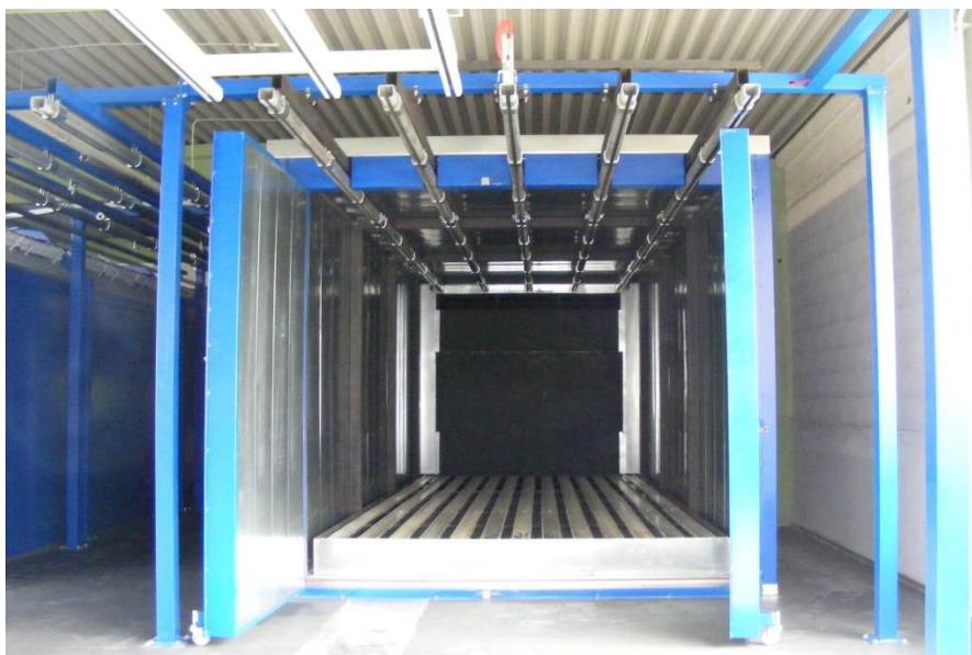
Figure 48 : tunnels pour l'étuvage des dattes après le trempage
