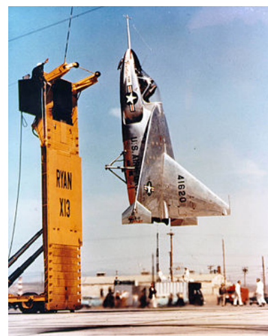
FIGURE 1.7 – X-13 sans train d'atterissage se prépare pour être mis à la verticale
