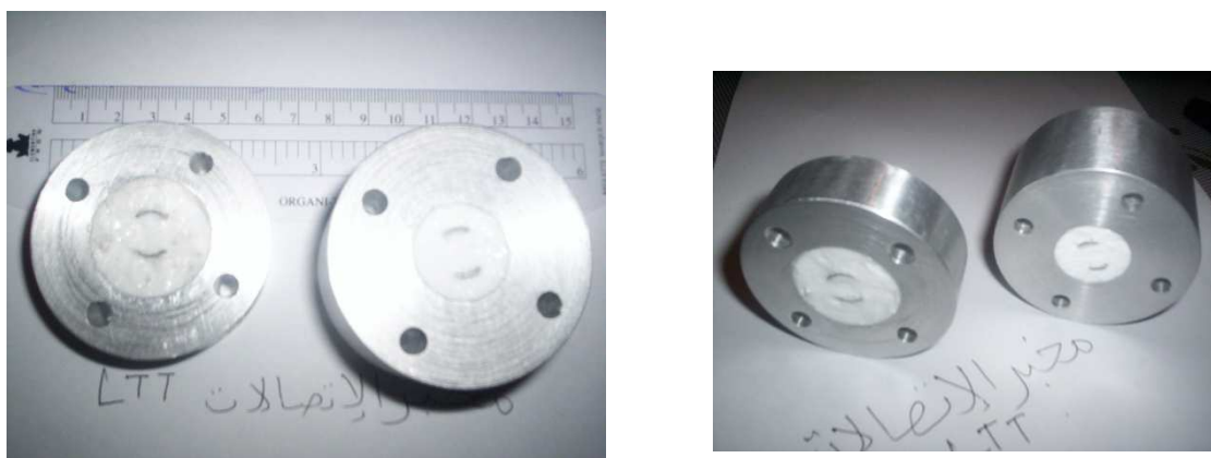
Figure IV.11 : Deux photos montrant nos réalisations pratiques de coupleurs STC.
