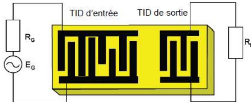
Figure III.4 : Schéma d'un dispositif à propagation d'onde acoustique de surface
