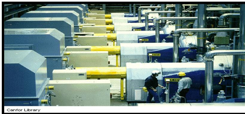
Figure 36: Raffineur de pâte mécanique
