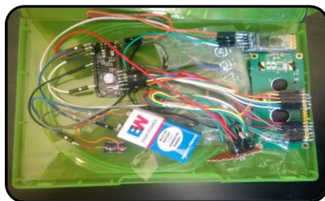
Figure III 13 : Vue interne du voltmètre
