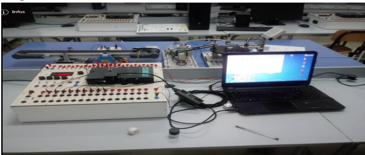
Figure III. 56 : Connexion PC avec l'automate Via MPI adaptateur.
