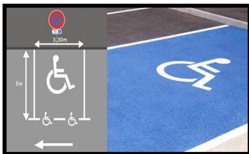
Figure 92 : stationnement pour handicapée
