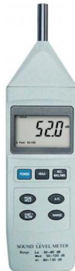
Figure 1.4 : Sonomètre numérique FI 70 -conforme IEC 61672 type 2 [1].
