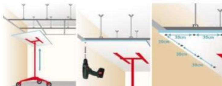
Figure 181 : montage de faux plafond
