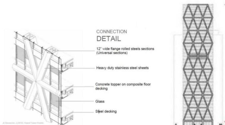
Figure 50:détail de façade diagrid
